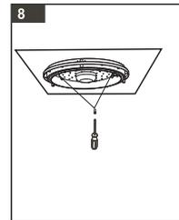
Connecter les câbles entre le plafond ou mur et l'appareil selon le schéma 7. Après avoir fini le câblage, visser la base du produit sur la surface souhaitée.
