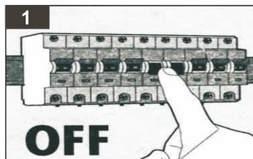
Etape 1/ Couper le courant électrique avant l'installation de ce luminaire.
