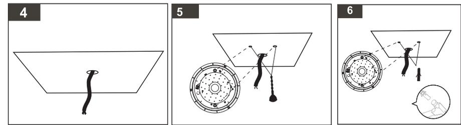
Etape 4-5-6 / Faire les trous sur la surface souhaitée en fonction des trous de la base de l'appareil.
