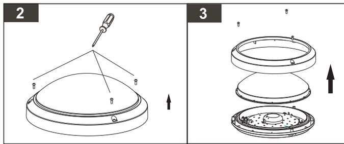
Etape 2-3 / Ouvrir l'appareil en dévissant les vis permettant de fixer la colerette du produit.
