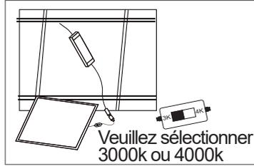
2. Raccorder le driver au réseau électrique
