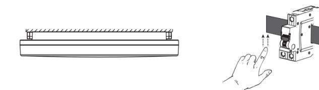
*Pour des raisons de sécurité, il est nécessaire de couper le circuit d'alimentation au réseau avant chaque intervention sur ce produit. L'installation doit être effectuée par un électricien professionnel, dans le respect des instructions de montage ainsi que des règles d'installation électrique, suivant la norme NF C15-100.*
