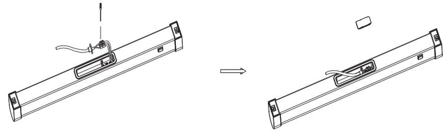
**Etape 3 : Déclipser les embouts de chaque extrémité de l'appareil.**
