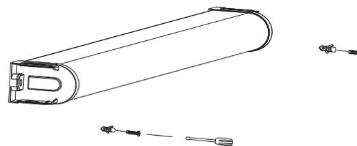
**Etape 8 : Reclipser les embouts de finition à chacune des deux extrémités de l'appareil.**
