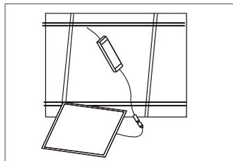
2. Raccorder le driver au réseau électrique
