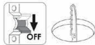
**Etape c :** Choisir la température de couleur grâce à l'interrupteur intégré sur le driver, comme ci-dessous : choix entre trois températures de couleur 2700K ou 3000K ou 4000K.
