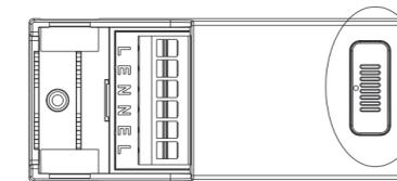
**Etape d :** Alimentez le driver au courant électrique en 220 volts et connectez le driver à l'appareil grâce à son connecteur rapide.
